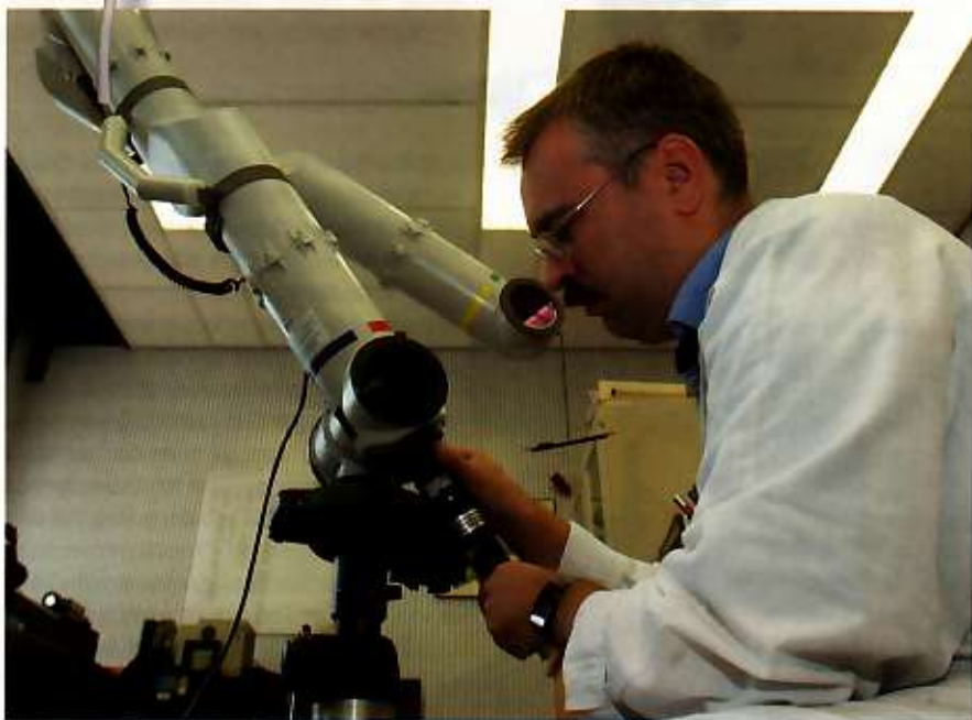
De kalibratieopstelling van de optische schaar.
